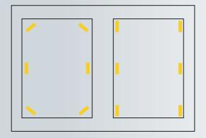
2) Entfernen Sie die Schutzfolie von jedem Klebestreifen
